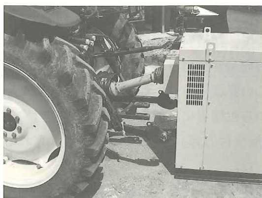
(写真2) トラクターのPTO軸に接続した発電機
